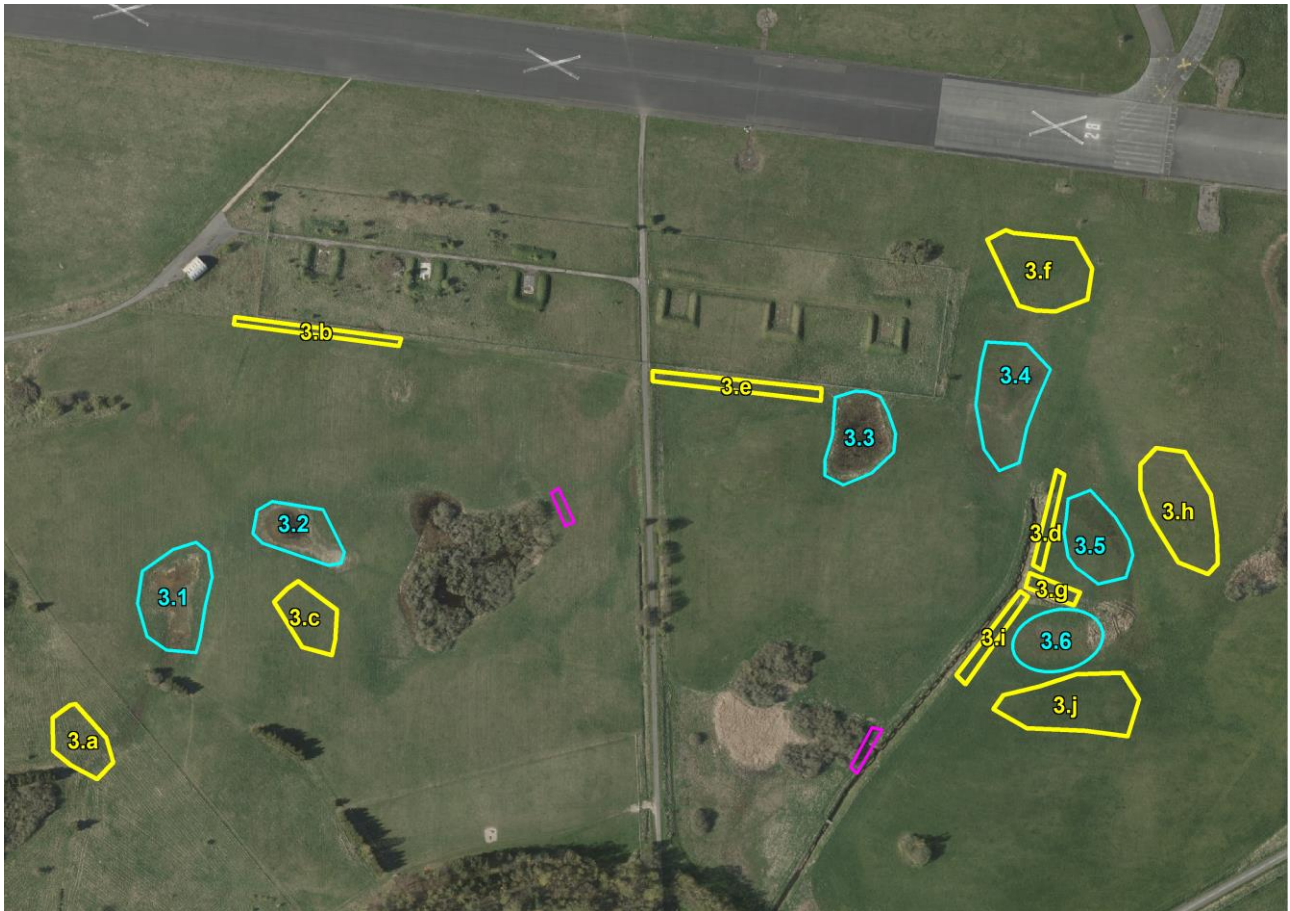
Figur 2. Oversigtskort over område 3. De udgravede arealer er markeret med lyseblå signatur. De gule arealer er de forventede placeringer af den opgravede jord. De cyklamefarvede arealer viser to eksisterende grøfter, der skal blokeres.
