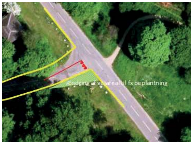
Forlægning af krydset mellem Laanshøjs Allé og Sandet.
