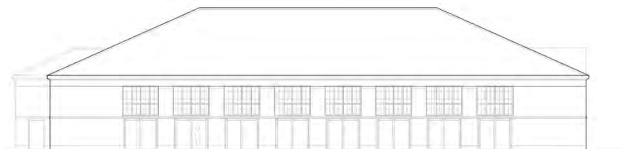
Sydfacade med nye fløjddøre i stueetagen
