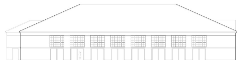
Sydfacade med nye fløjdøre i stueetagen
