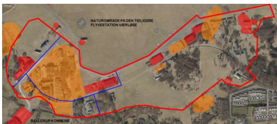
Figur 8. Kortlagt jordforurening marts 2016. Kortskitsen herover viser jordforurening kortlagt på V1 med røde flader og jordforurening kortlagt på V2 med orange flader.
