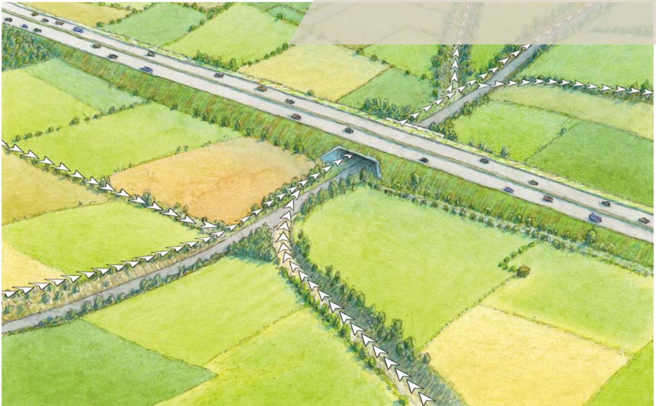
Fig. 1. Tunnel under en 2 sporet vej med ledelinjer, der leder lavtflyvende flagermus til og igennem tunnelen. Tegning Peter Twisk.
