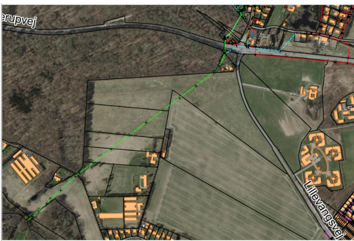
Forløb af det rørlagte vandløb fra området ved den tidligere Farum Kaserne til Vassingerødrenden.
